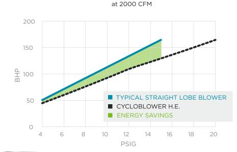
BRAKE HORSEPOWER REQUIREMENT COMPARISON
