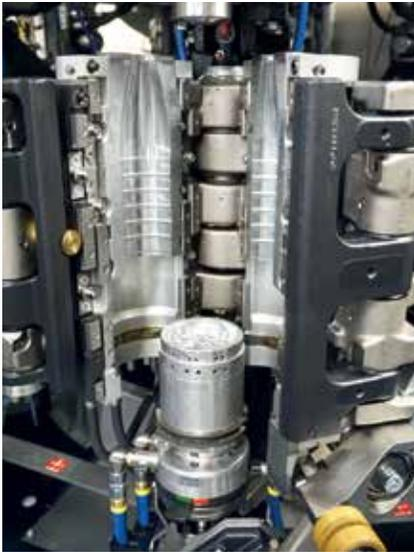
Las botellas pre-moldeadas del tamaño de un pulgar son "infladas" con aire comprimido a presiones de hasta 580 psig.
