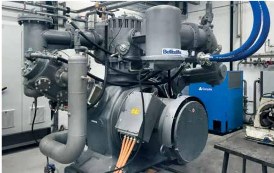
**Compresor alternativo exento de aceite Tipo WH 29 3N, accionado directamente con un motor sin eje de 435 HP y un flujo de volumen máximo de 1.024 CFM (FAD) a 580 psig**
