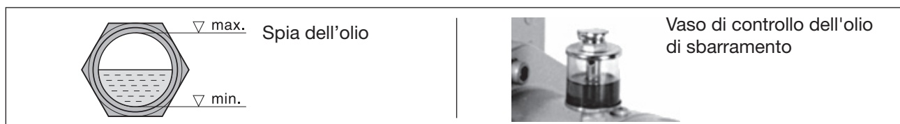
Fig. 7 Livello dell'olio sulla spia e sul vaso di controllo dell'olio di sbarramento
