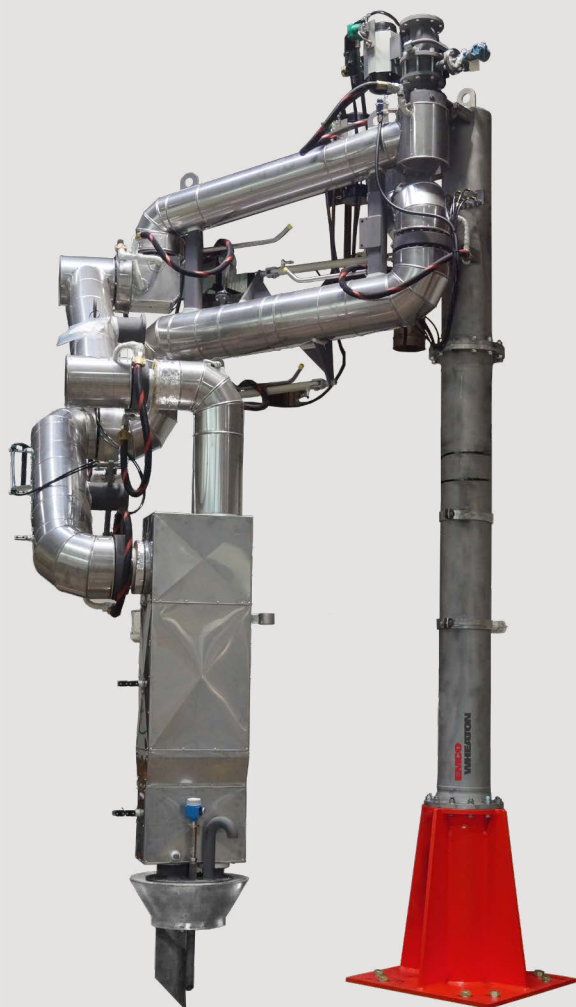
Bras de chargement parallèle avec système de chauffage à vapeur revêtu et illustration
